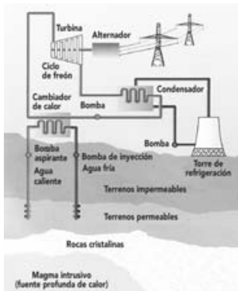
Figura 8. Esquema de funcionamiento de una central geotérmica
