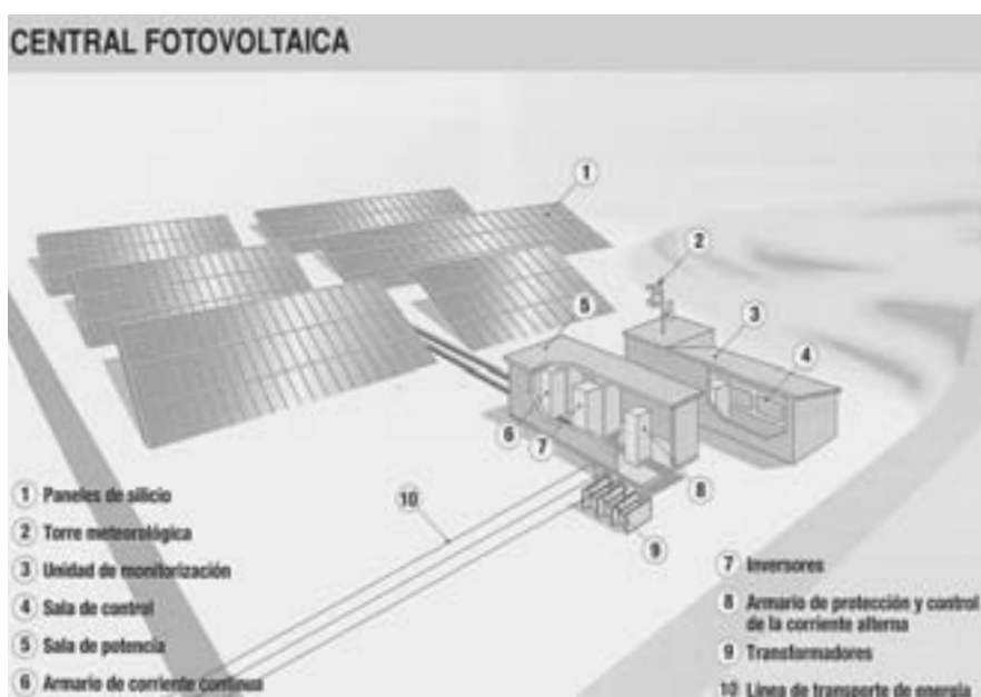
Figura 7. Esquema de aprovechamiento de energía solar (Fuente: UNESA)
